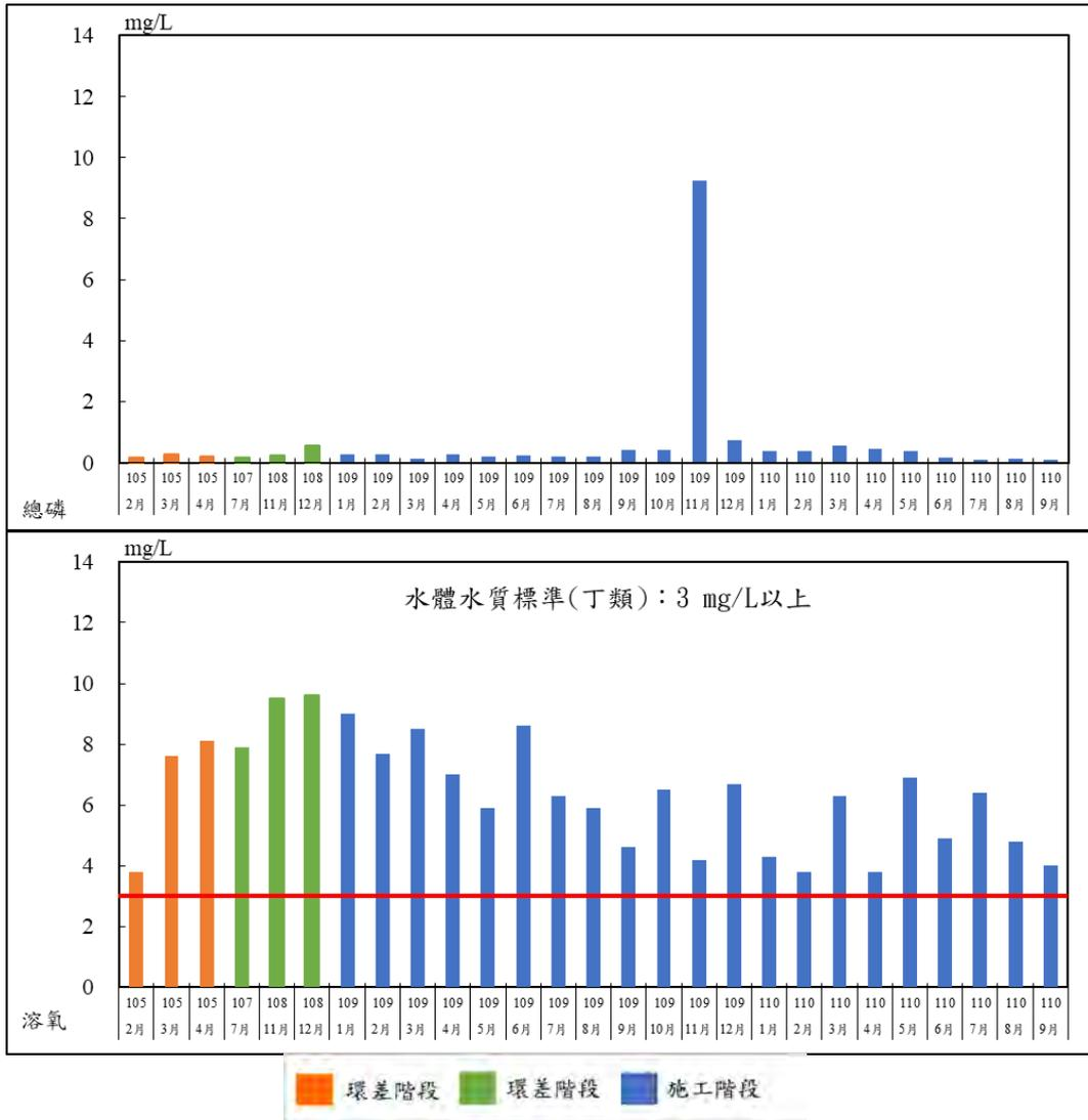
圖 3.1.15-1 歷次竹南人工暫定重要濕地水質監測結果變化情形
