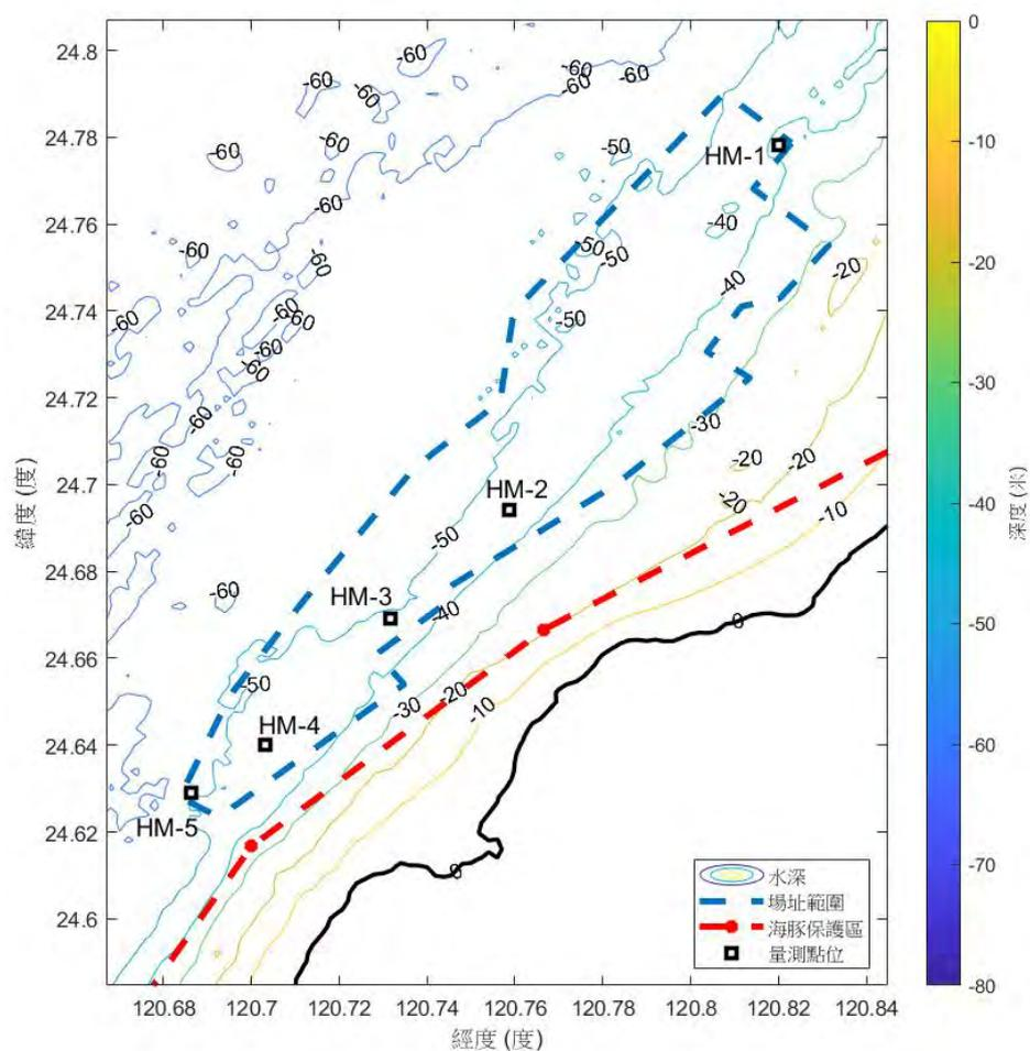
圖 1.3.3-10 水下噪音量測點位示意圖
