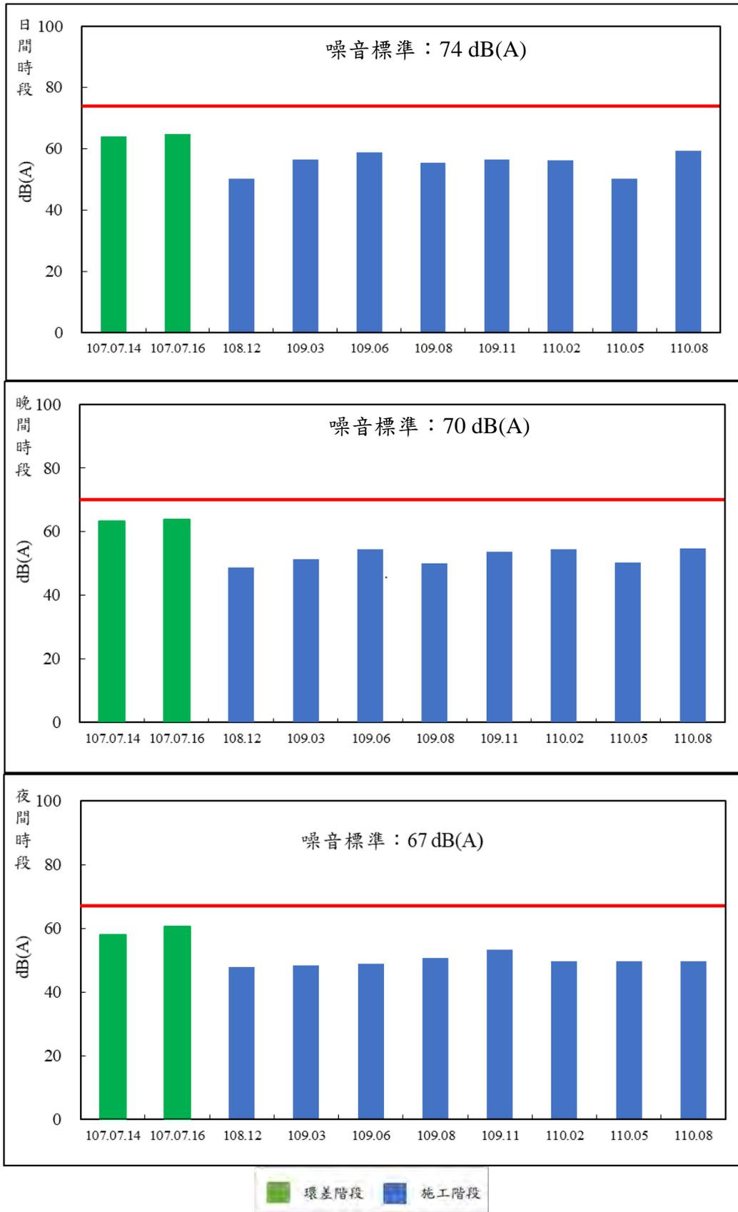
圖 3.1.14-1 歷次升壓站附近民宅噪音監測結果變化情形
