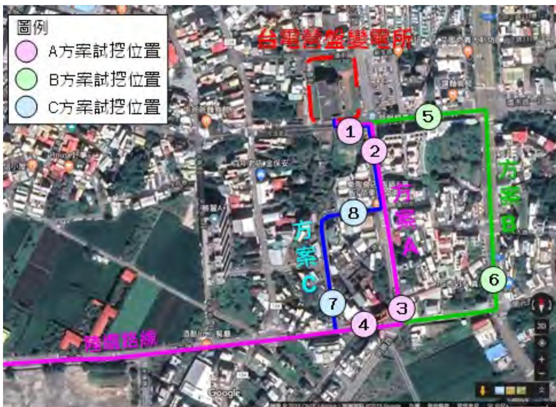
圖 1.3.3-9 陸纜路徑 A、B、C 方案地下管線試挖地點示意圖
